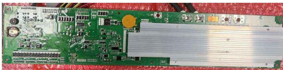
Photo 4 电池组保护板背面 Back view of PCM
