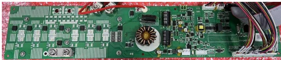
Photo 3 电池组保护板正面 Front view of PCM
